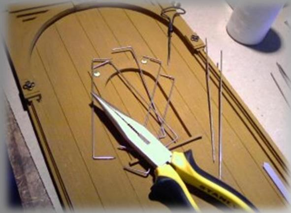
Para la realización de la reja, utilizaremos alambre rígido, que lo cortaremos con unos alicates de corte y daremos forma según se muestra en la fotografía.
