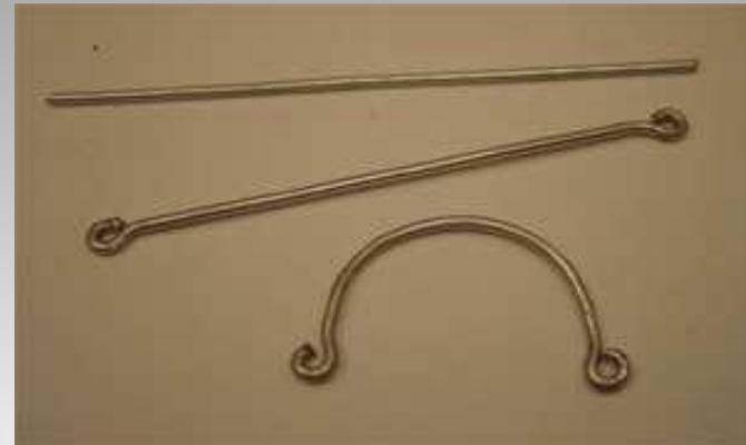
7) Con alambre de 2 milímetros realizamos el asa del cubo.
