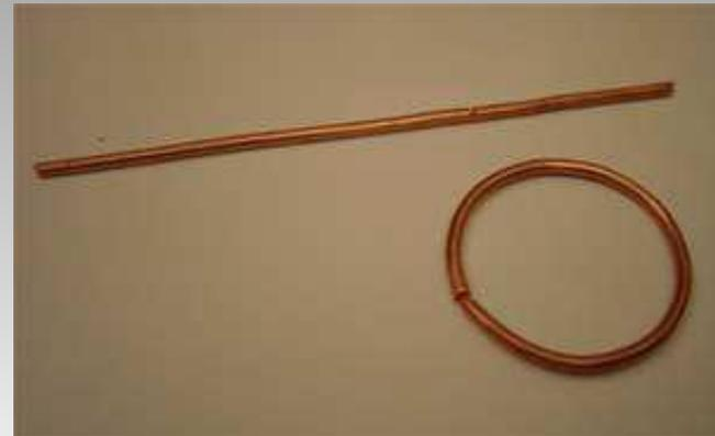
8) Para reforzar el borde superior del cubo cortamos un alambre de cobre de 2 milímetros de espesor y 82 milímetros de largo. Como vemos en la imagen, cortamos el alambre de cobre y le damos forma circular.
