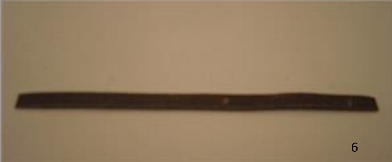
6) A continuación recortamos de la plancha de zinc una tira de 3 milímetros de ancho y 61 milímetros de largo. La pieza cortada y lijada que será una vez soldada la base del cubo.
