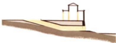
En primer lugar, se amplió considerablemente la explanada, lo que exigió grandes proezas de ingeniería. El muro de contención debía resistir grandes tensiones. Dos de sus esquinas colgaban sobre el valle y la plataforma estaba allí a unos 45 m. por encima del suelo. En la esquina del sureste hubo que sostener la plataforma con una serie de arcos, conocidos en la actualidad como los establos de Salomón.
